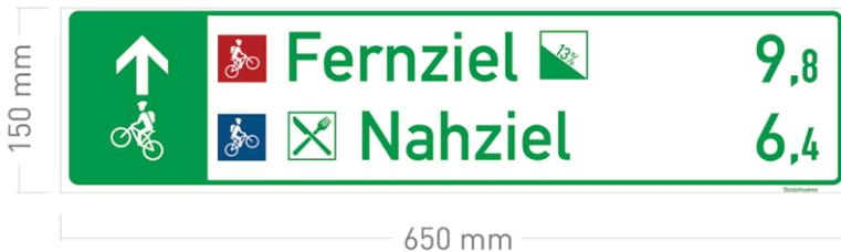
Liegt der Wegweiserstandort nicht auch auf dem Radnetz, wird ein Format von **650 x 150 mm** verwendet. Dieses kleinere Format ist vor allem in naturräumlich sensiblen Gebieten sinnvoll, damit dort nicht eine überdimensionierte Wegweisung steht.
