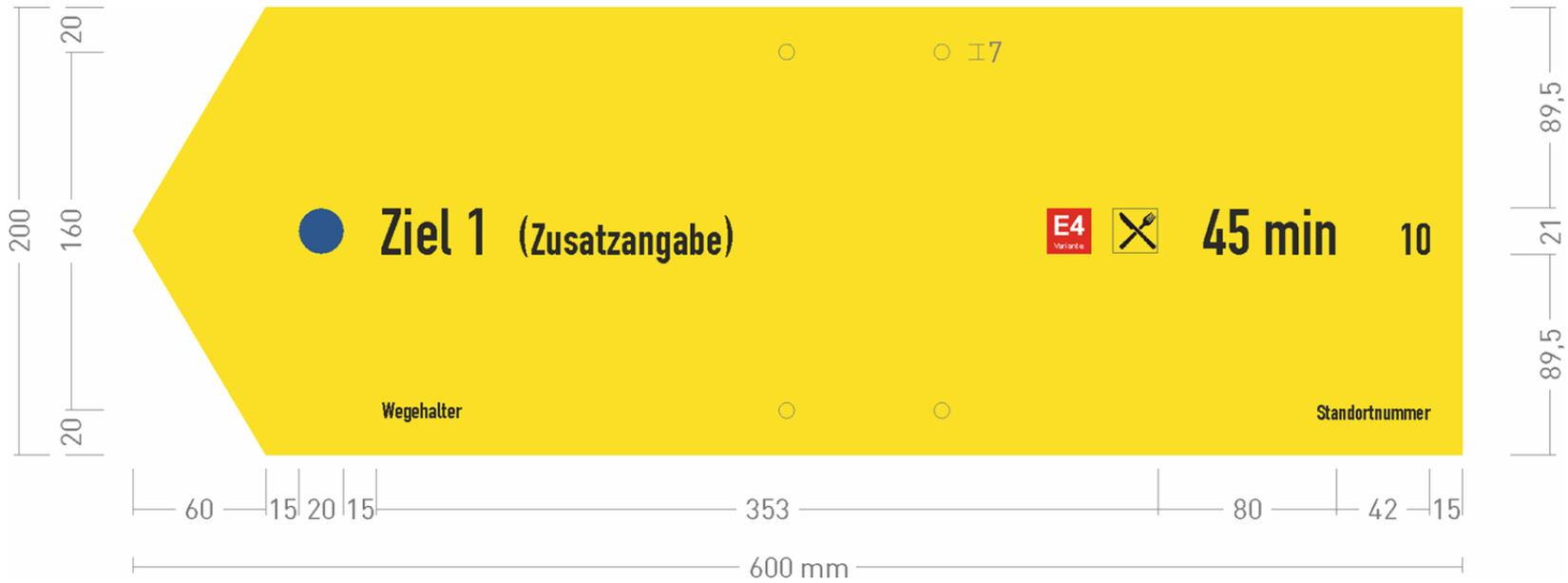
Abbildung: Bemaßung eines 1-zeiligen Zielwegweisers für die Bergbereiche
