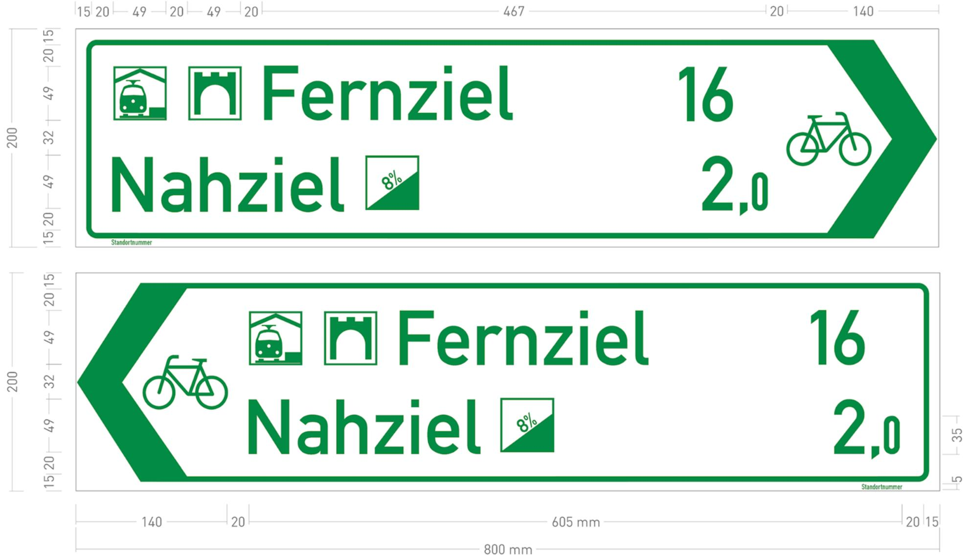
Bemaßung der Radwegweisung: Pfeilwegweiser 800 x 200 mm (einzeilig)
