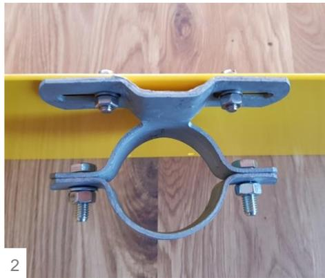
Die gelbe Bergwanderwegweisung sollte immer mit Rohr- oder Bandschellen aufgehängt werden, welche mittig an den Wegweisern angeordnet werden.
